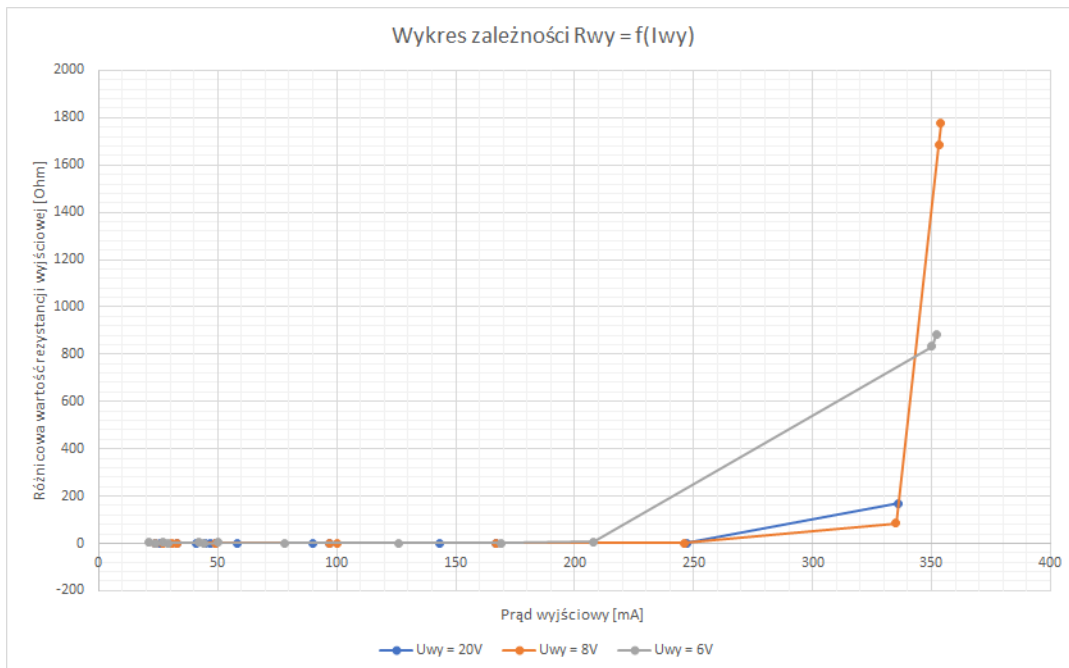
Rysunek 7: Wykres zależności R_{wy} = f(I_{wy})
