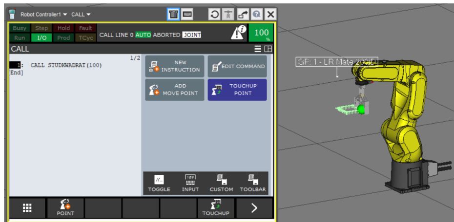
Rysunek 11: Wywołanie programu StudKwadrat w nadrzędnym programie z parametrem.
