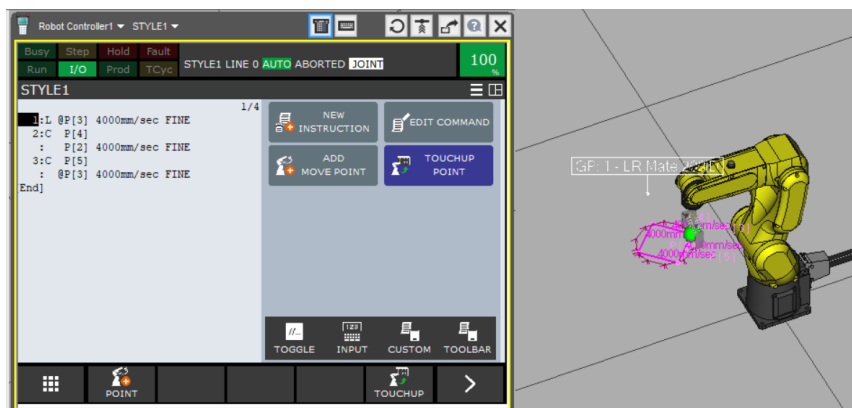
Rysunek 3: Ruch końcówką roboczą manipulatora po okręgu.
