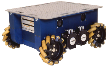
Rysunek 1: Przykładowy robot wykorzystujący koła mecanum; źródło: [1]
